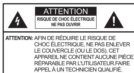
L'éclair avec symbole de flèche dans un triangle équilatéral avise l'utilisateur de la présence d'une tension dangereuse non isolée dans le boîtier du produit et qui peut être d'intensité suffisante pour présenter un risque de choc électrique.
