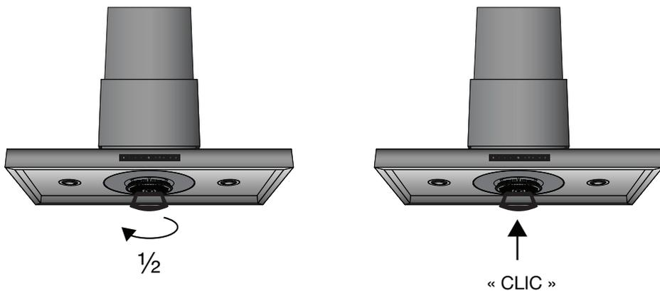
7. Desserrez complètement l'instrument de service en le tournant vers la gauche.
