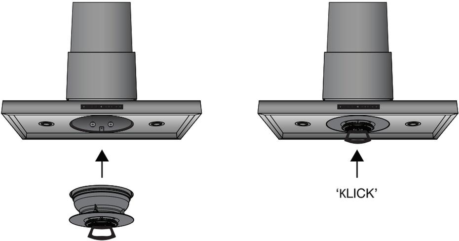
6. Drehen Sie den Serviceschlüssel eine halbe Umdrehung nach links und drücken Sie die Einheit nochmals, bis Sie ein „Klick“ hören.
