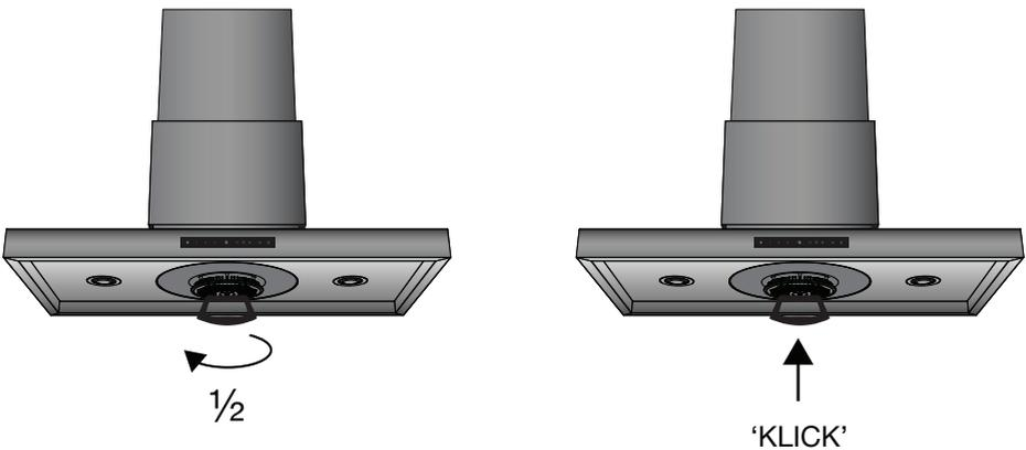
7. Drehen Sie den Serviceschlüssel linksherum vollständig lose.
